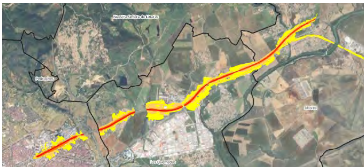
Imagen 34. Detalle de zona de afectación por el Tráfico ferroviario
